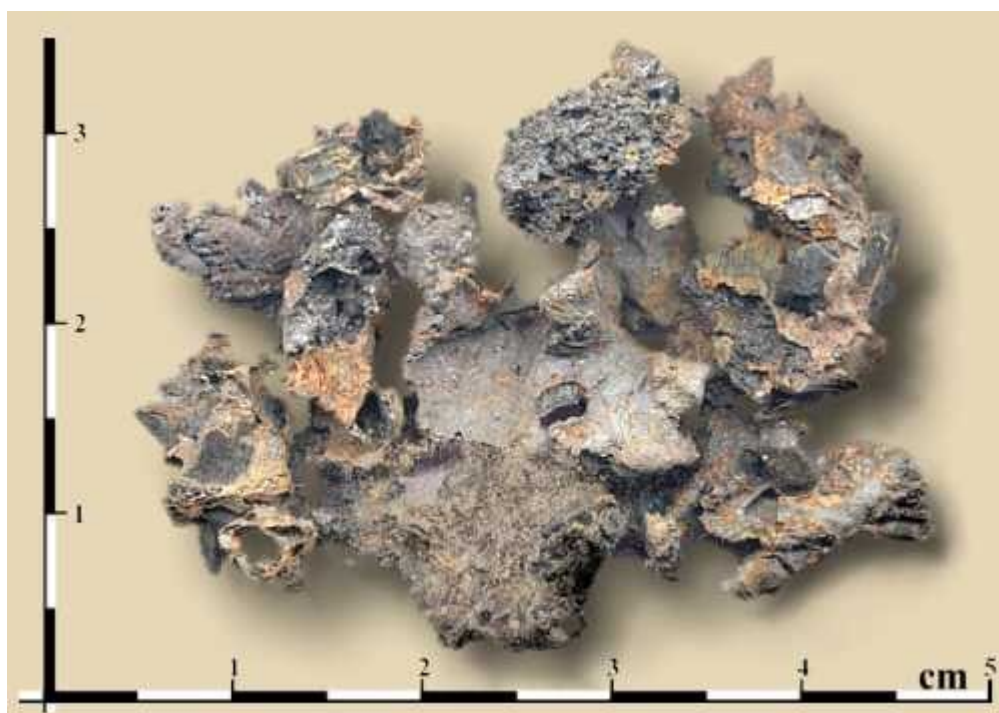
Rys. 3 Fragment łupki żelaznej uzyskanej w doświadczalnym piecu dymarskim.
